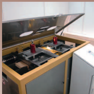
Essai de traction du bois
